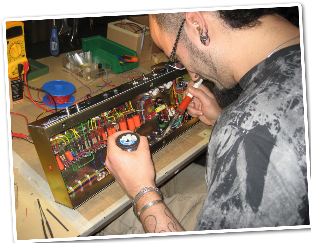
● Enric realizando las últimas soldaduras de un Thunderbird.
