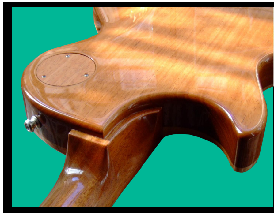
Detalle del rebaje para facilitar el acceso a los trastes altos y de la unión del mástil al cuerpo.
