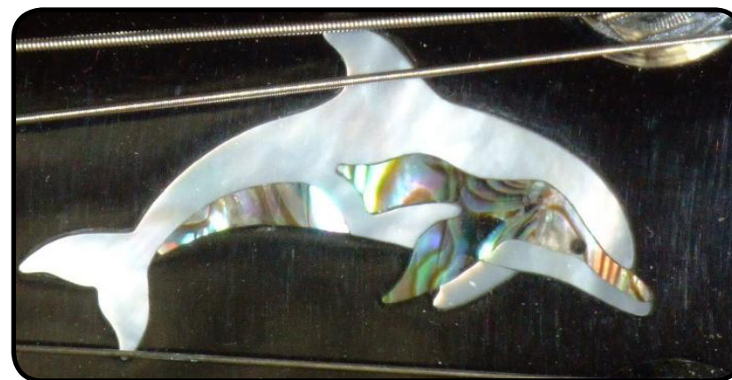
Detalle del delfín taraceado en la pala compuesto de ábalon y madreperla
